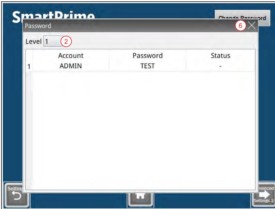
1. Sur la page **Advanced Settings 1** (Paramètres avancés 1), appuyez sur **Change Password** (Modifier le mot de passe) dans le coin supérieur droit de l'écran.
