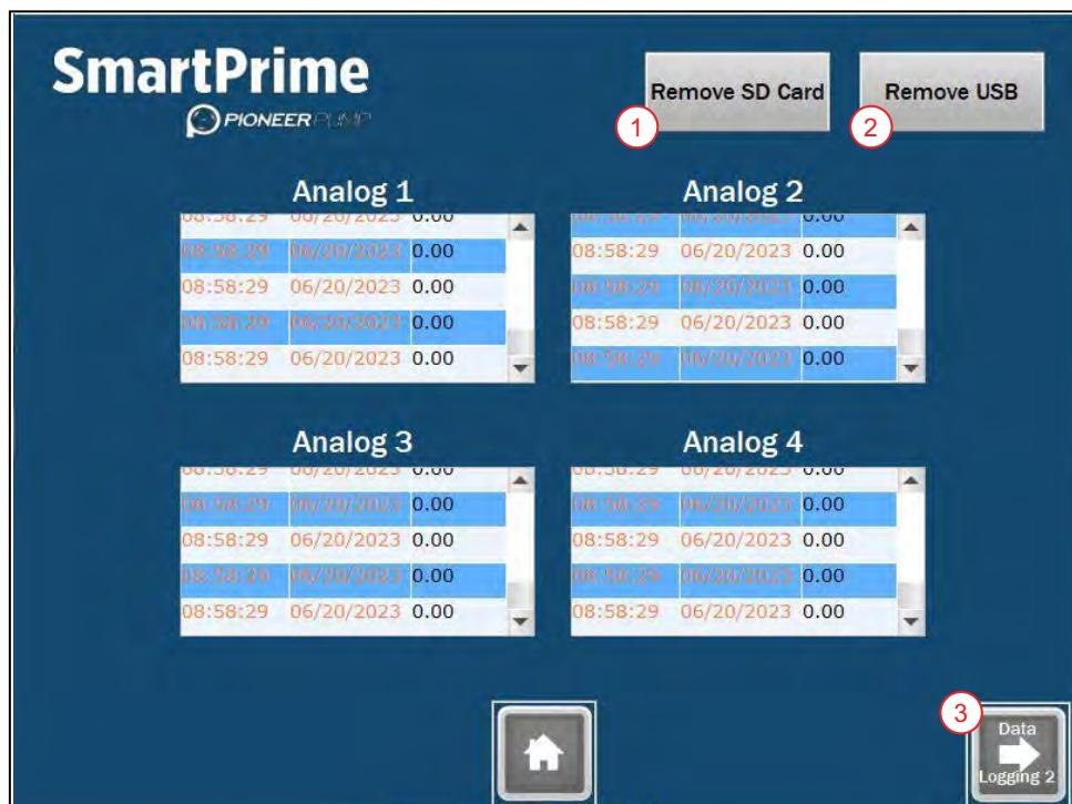
1. Botón **Remove SD Card** (Remover tarjeta SD): presione antes de retirar la tarjeta SD de la HMI para detener la lectura.
